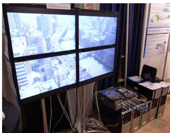
図5：タイルドディスプレイウォール。高品位動画伝送のデモンストレーションとして、大阪からの実況映像を表示している。
